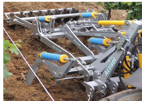
Cultivateur dents rigides combiné à des bêches roulantes
